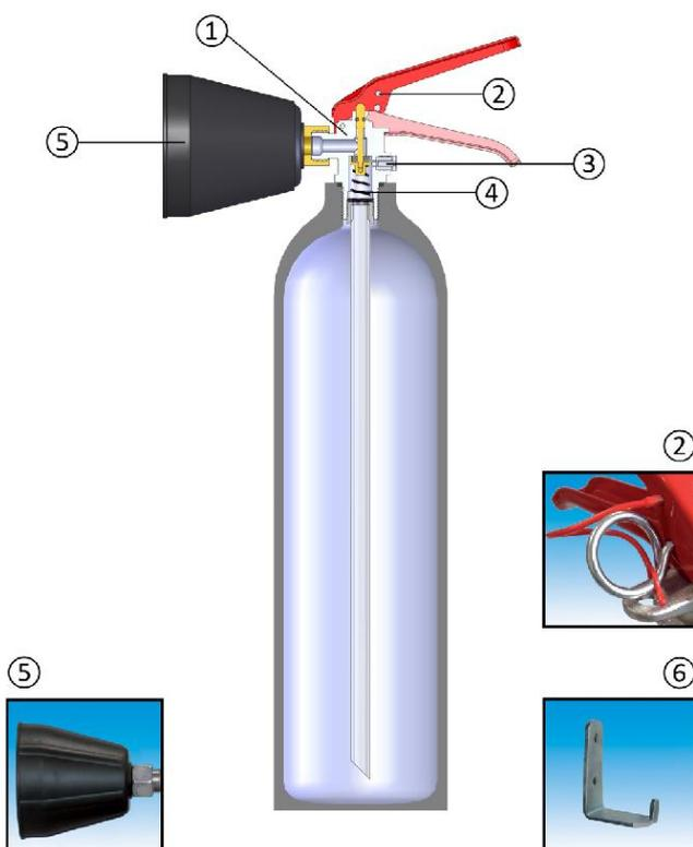
① La vanne est formée d'une pièce en laiton moulée .
