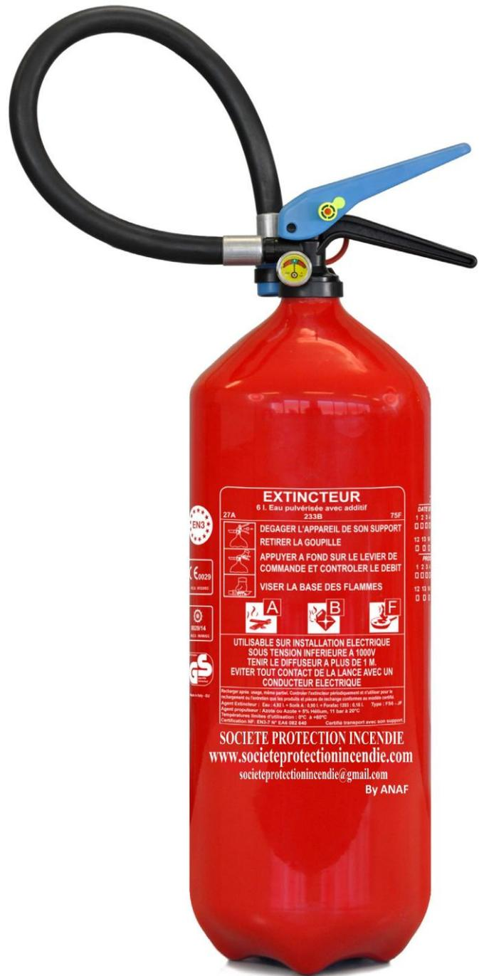
E6M est un extincteur pressurisé à eau additivée avec corps en aluminium et manomètre. Ce modèle a effectué l'essai diélectrique à 35 kV et peut donc être utilisé sur feux d'origine électrique. Notre extincteur est recommandé sur les feux de classe F.
